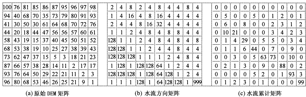
图 2 一个简单的 DEM 矩阵及其计算结果(AEDNM 计算结果)
